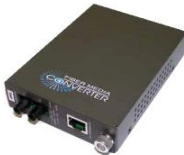
Repetidor fibra/par trenzado
